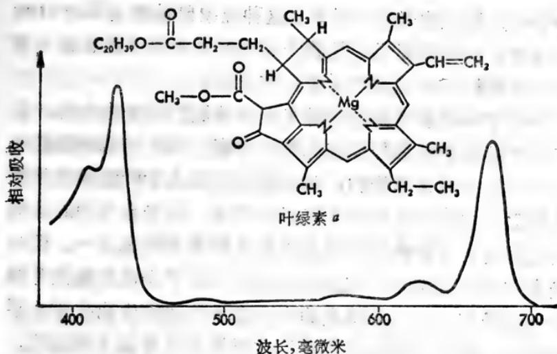
图7.5 叶绿素a的吸收光谱和结构
