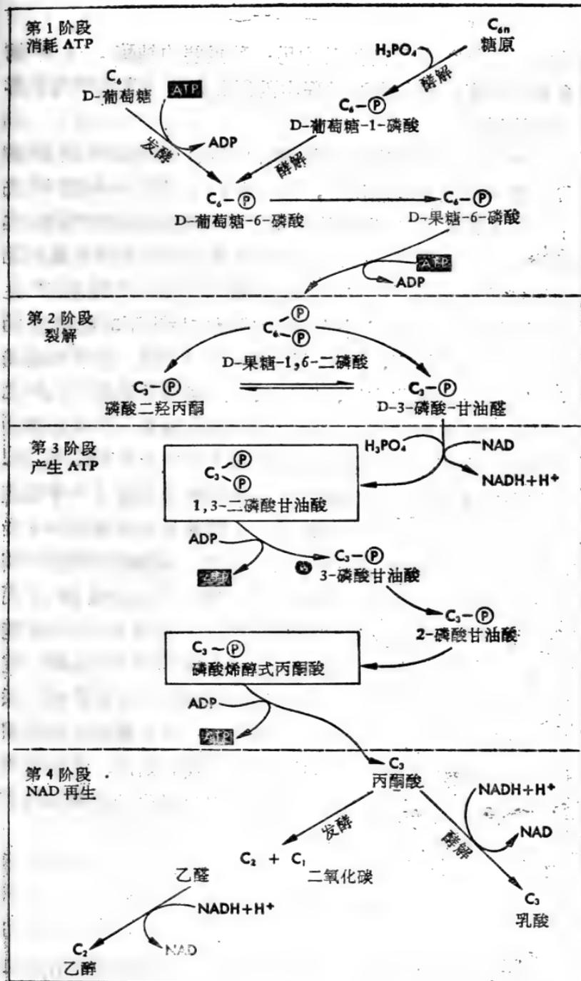
图6.1 乙醇发酵和糖酵解的梗概
