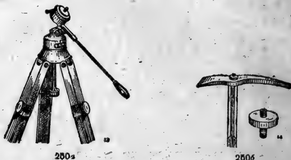
圖 250 a—窄片攝影機用三腳架，帶有手柄，可以橫搖鏡頭和豎搖鏡頭 圖 250 b—水鏡和裝在其上供連接鏡箱用的螺絲頭
