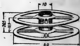
圖 259. 16 毫米電影膠片用的試樣顯影圈，賽璐珞製(尺寸單位：毫米)
