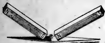
圖 352. 羅盤磁針的磁化
