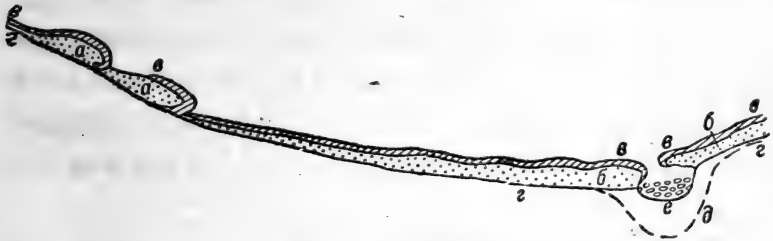
图 2 土流坡断面图
