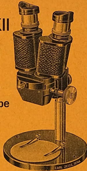
Binokulare Stativlupe XII Vergrößerung 4× – 43×
