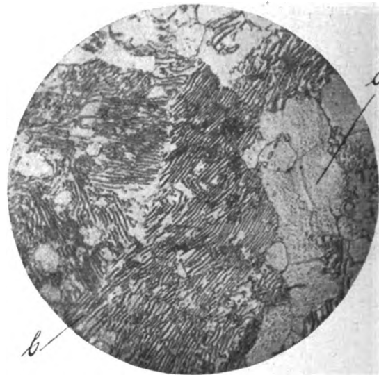
Fig. 13. Ferrit (a) und Perlit (b). 600 fache Vergrößerung.
