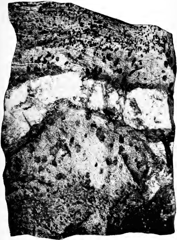
Quarzgang, zu beiden Seiten die abnorm grobkörnige Spezialkontaktzone und weiterhin den Übergang zu normalen Fruchtschiefer zeigend. Talsperrenbau der Stadt Plauen im Geigenbachtale. Natürliche Größe. (Zu S. 196.)
