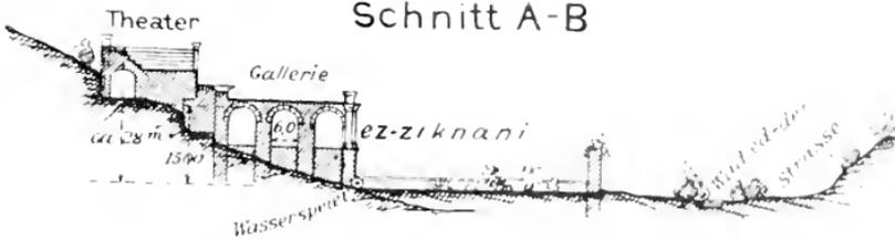
Abb. 42. Querschnitt des Wasserbehälters ez-ziknani.
