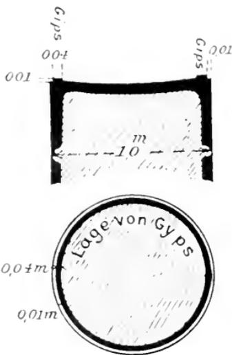
Abb. 3. Horizontale Lagerfläche der Säulen der Hauptstrasse.
