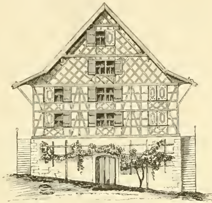
Ständerbau mit Kiegelwand. (Vendition.)
