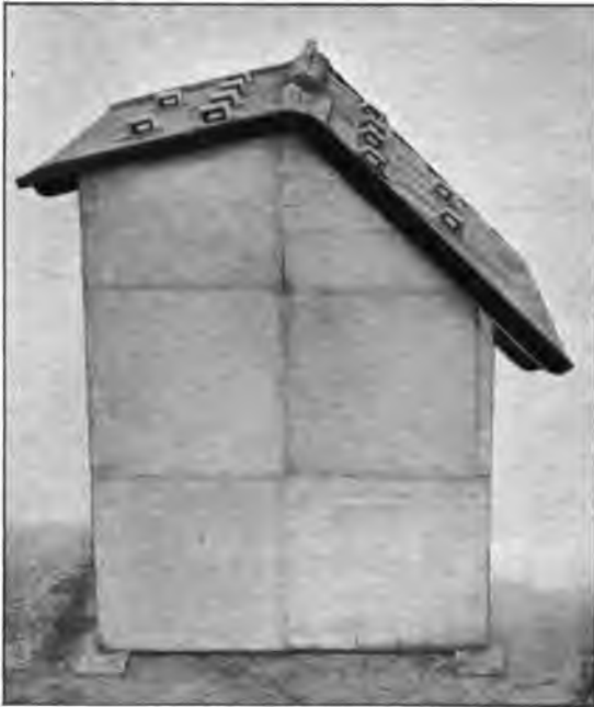
Fig. 6. Dachmodell mit Ventilationskappen.
