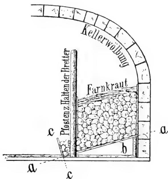
Das unterste Brett der Vorderwand fehlt, und ist auf dem verlängerten Boden (*a—a*) das etwas grössere Brett *c—c* angebracht, wodurch eine Art Krippe entsteht, die durch den Druck der Kartoffeln immer gefüllt bleibt. Bei Bedarf werden die Knollen stets von unten aus dieser Rinne entnommen und durch das Nachdrücken der anderen bleibt der ganze Haufen in Bewegung. Dabei strömt durch das ganze Lager frische Luft und die übermässige Bildung von langauswachsenden Trieben, sowie das die Sporen-
