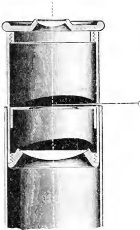
Die Änderung, welche an dem Okular angebracht werden muß, besteht einfach in einer kleinen seitlichen Öffnung gerade oberhalb der oberen Fläche des Diaphragmas. Die Öffnung muß so groß sein, daß eine mittelgroße Stecknadel (etwa 3 cm lang) dieselbe gerade bequem passieren kann. Nebenstehendes Bild zeigt die Vorrichtung. Da das Okular bei dem Einbringen auf den oberen Rand des Tubus mittels des außerhalb des Okulars befindlichen Teiles der Stecknadel sich stützt,
