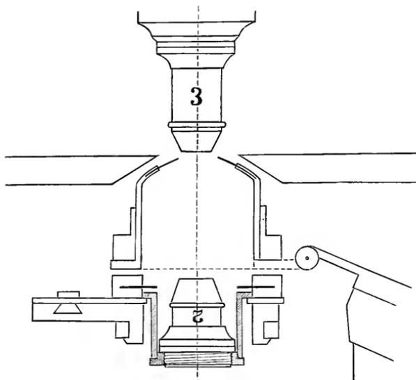
Der Diaphragmaträger des ABBESchen Beleuchtungsapparates mit in denselben eingesetztem umgekehrtem Objektiv und die obere Irisblende beim ausgeklapptem Kondensor (rechts).
