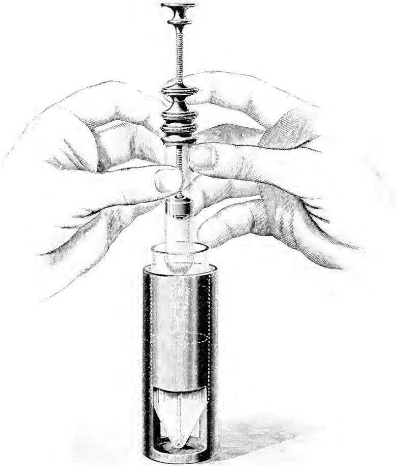
keit, in welcher das untere Ende der Kanüle sich eventuell befindet, aufgesaugt wird. Der Schraubenring trägt an irgendeiner Stelle ein Merkzeichen, so daß man bequem beurteilen kann, wie groß der Kreisabschnitt gewesen ist, welchen jeder Punkt der Schraube durchlaufen müßte, um das Zentrifugat entweder ganz oder den gewünschten Teil desselben in das untere Ende der Kanüle aufzusaugen.
