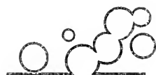
Schematisch abgebildeter Kanal in der Glasur, auf Grund der Mikrophotographien. (Siehe Tafel V.)
