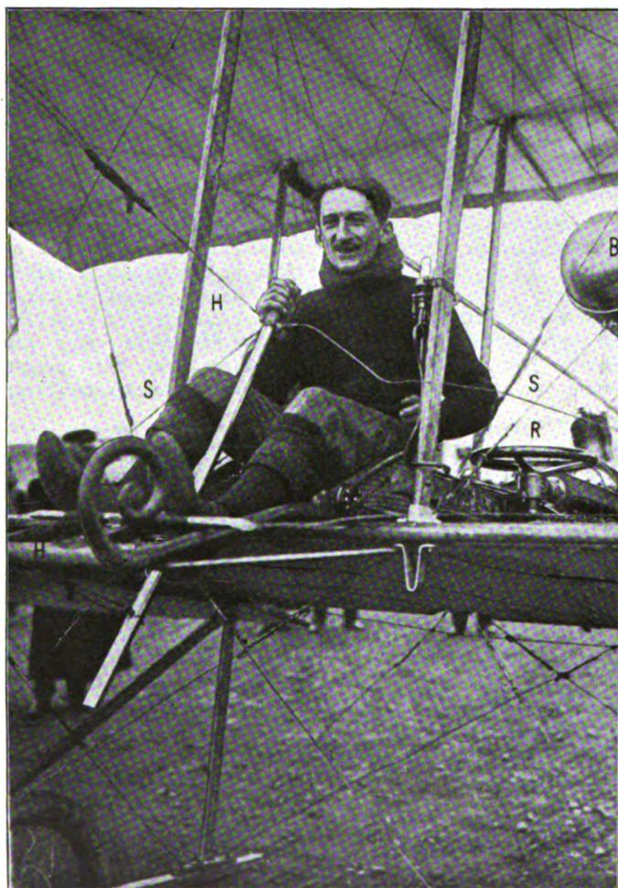
Fig. 3. Führersitz des Zweideckers Roger-Sommer (Führer Legagneux) rechte Hand am Steuerhebel. *H* Drahtseile für das Höhensteuer, *S* Drahtseile für die seitlichen Stabilisierungsflächen, *R* Handrad zum Einstellen der Schwanzfläche, *B* Benzinbehälter (Motor Gnôme).
