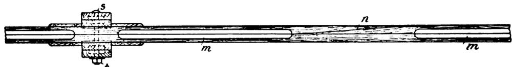
Fig. 4. Rettigsche Holzversteifung für Luftschiffe. Schnitt durch die Holzstäbe.
