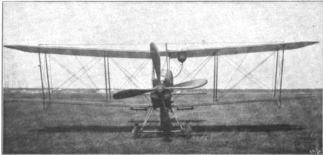
Fig. 26. Einbau des 100 PS engl. Daimler-Motors, Typ R.A.F. (Renault) im „B.E.“ Doppeldecker.
