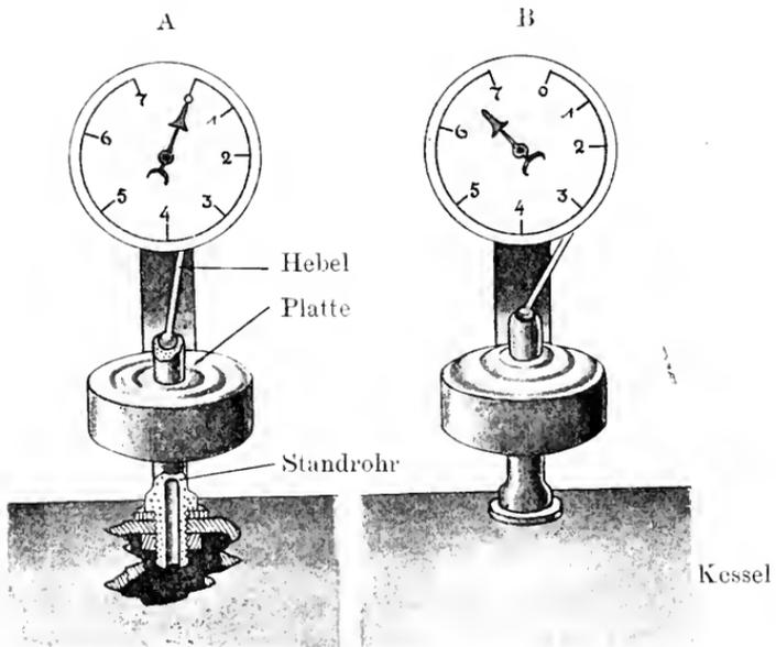
Fig. A u. B. Schema eines Hebelmanometers mit Platte aus gewelltem Blech.
