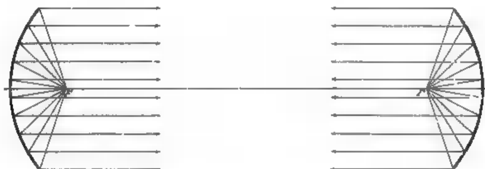
Parabolische Hohlspiegel-Anordnung nach Busse-Kral.
